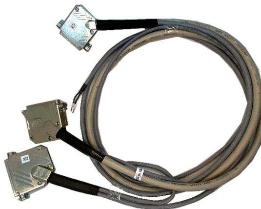
**Рис.4.10.** Соединительный кабель TER\_RecUnit\_Harness\_184
