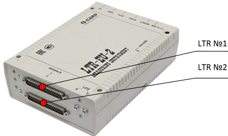
**Рис.5.2.** Подключения кабеля к ЦАП
