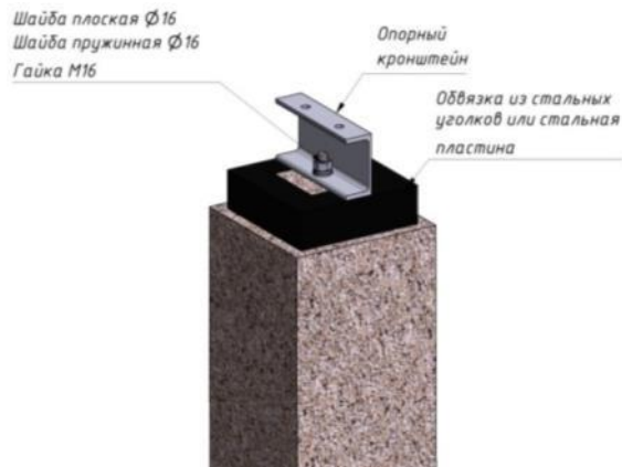
Рис.5.54. Крепление опорных кронштейнов при помощи шпилек
