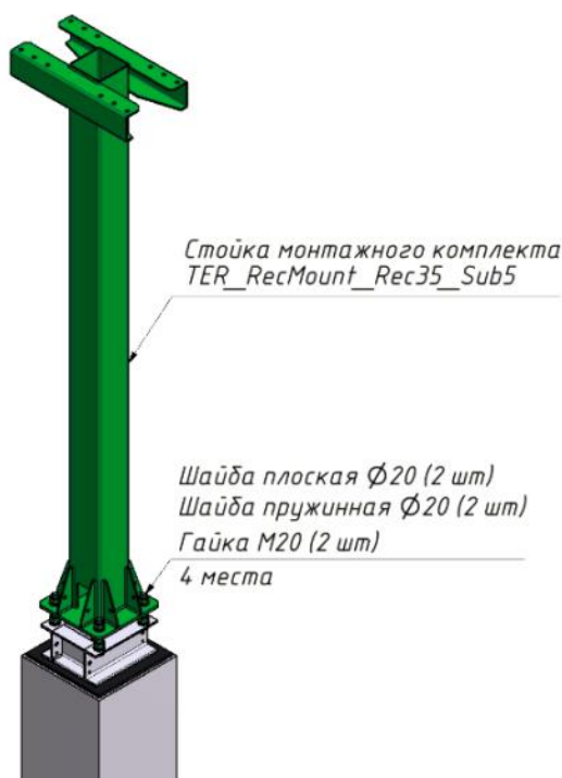
Рис.5.82. Установка стойки
