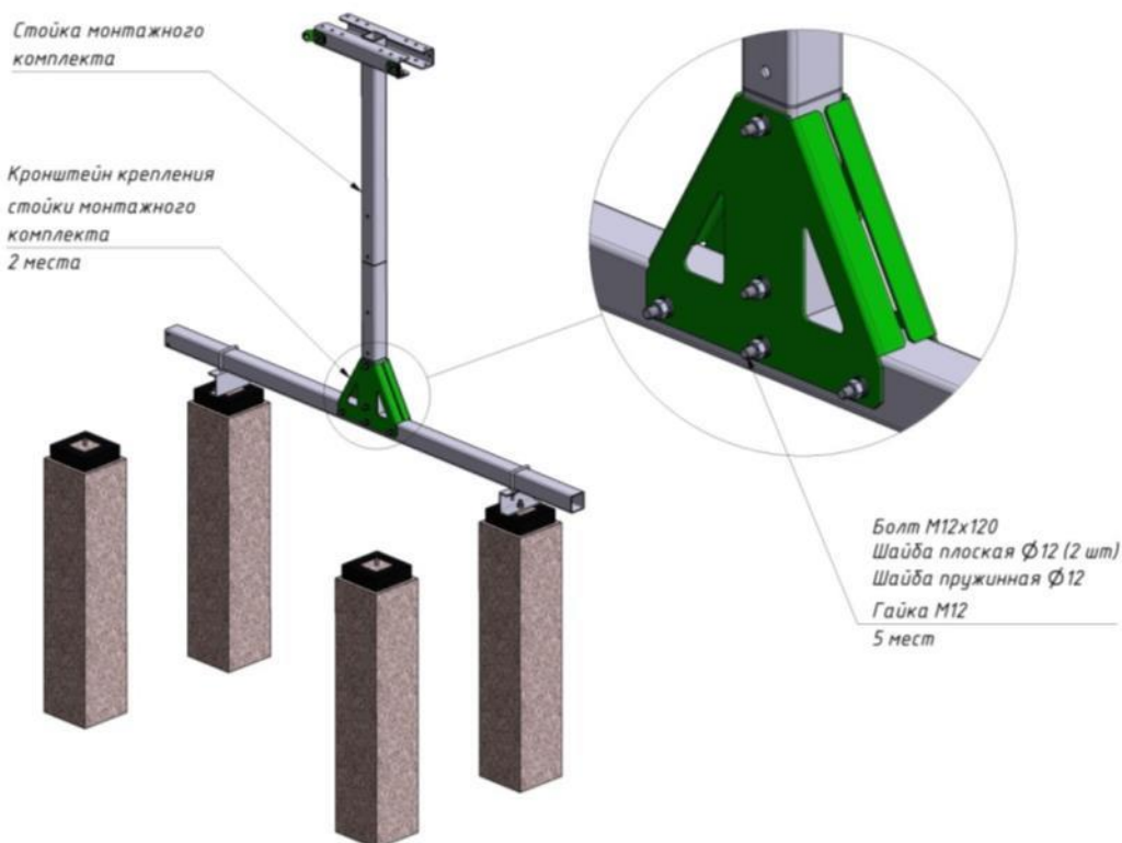
Рис.5.61. Установка стойки
