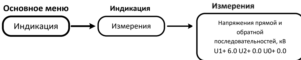
Рис.6.5. Контроль напряжений симметричных составляющих
