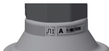
Рис.5.51. Маркировка начала первичной обмотки Л1
