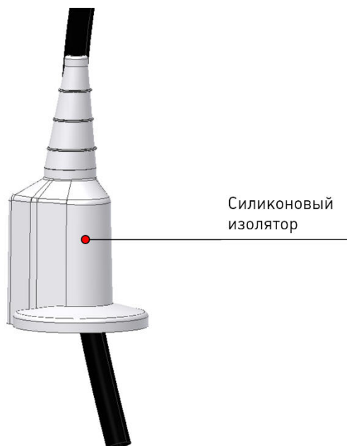
Рис.4.29. Установка силиконового изолятора
