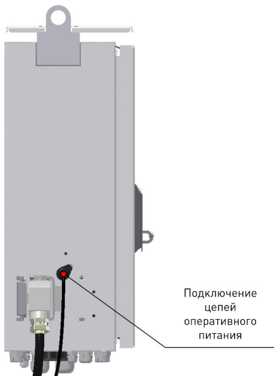
Рис.4.7. Подключение кабеля оперативного питания к шкафу управления
