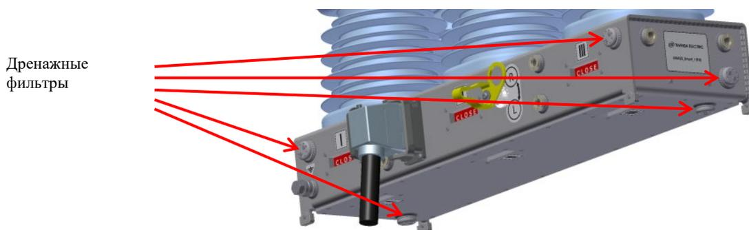
**Рис.5.2.** Расположение дренажных фильтров
