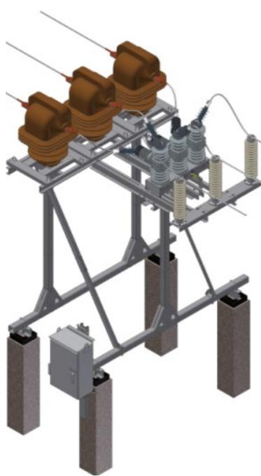
Установка реклоузера и трансформаторов тока на четыре точки опоры (сваи)
