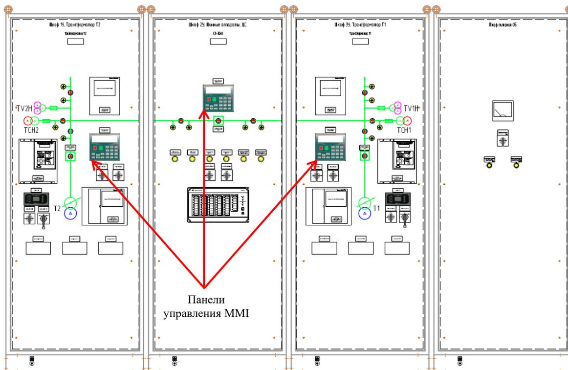
Рис.5.8. Пример расположения панелей MMI на панелях защит 35кВ
