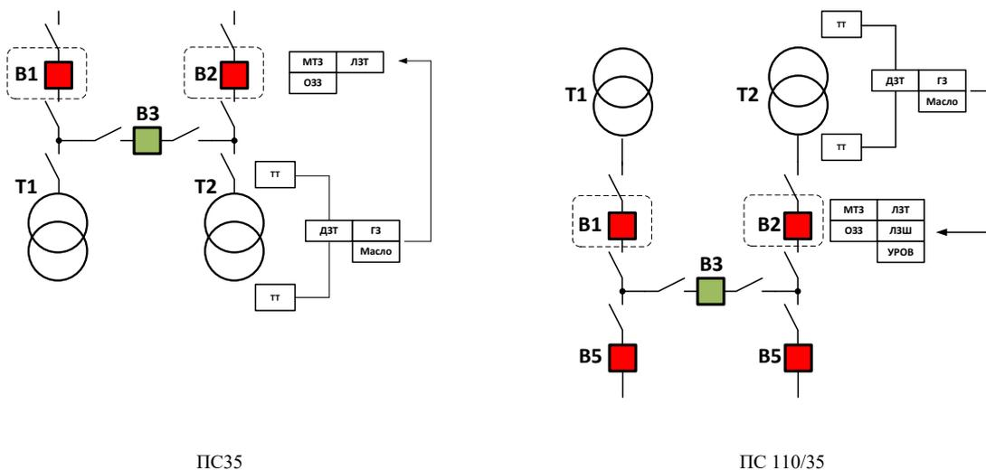
Рис.7.1. Применение Smart35 в качестве выключателя ввода
