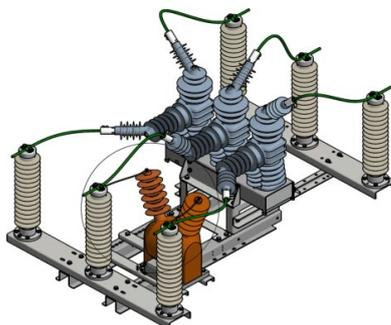
**Рис.7.3.** Установка Smart1 на существующую металлоконструкцию
