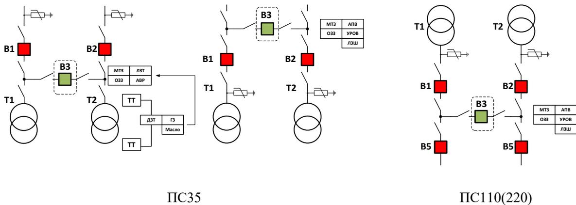
Рис.7.6. Применение Smart35 в качестве секционного выключателя
