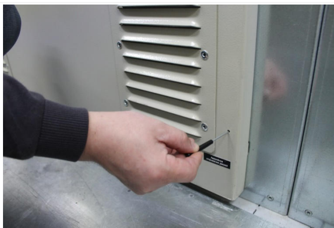
Рис. 2.20 Отверстие аварийного открытия двери отсека ВЭ
