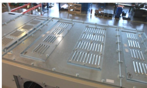
Рис.1.24 Клапаны сброса давления ВССШ
