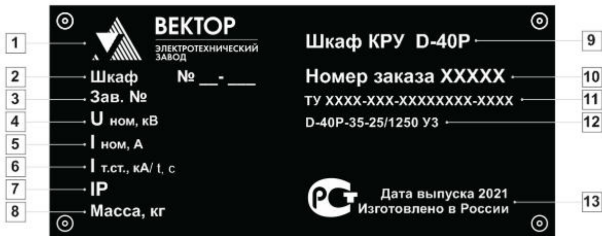
Рис. 1.12 Маркировочная табличка каждого шкафа КРУ
