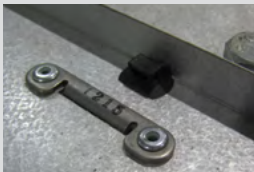
Рис. 10.3. Пластиковый фиксатор клапана сброса давления
