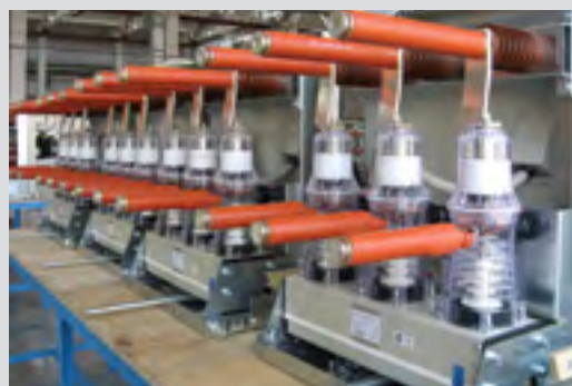
Рис. 6.9. КВЭ на базе выключателей ВВ/TEL
