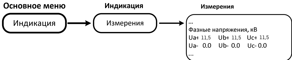
Рис.5.3. Просмотр наличия напряжения с панели управления. Сеть 20 кВ.
