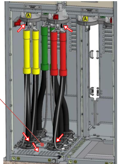
Рис.6.21. Монтаж вторых кабелей фаз А и С (боковые стенки двух смежных шкафов условно не показаны)
