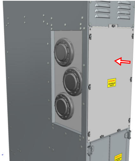
Рис.4.52. Монтаж клапана ОСШ
