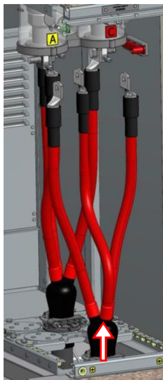
Рис.6.27. Подготовка к монтажу второго трехжильного кабеля
