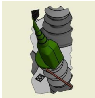
Рис. 4.28. Место подключения провода к коммутационному модулю в сборе
