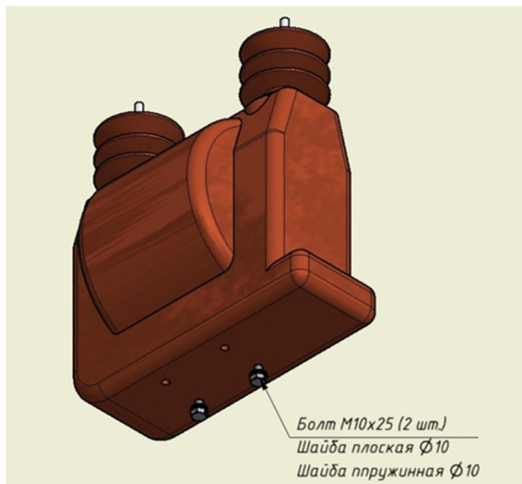
Рис. 4.22. Установка болтов для монтажа ТСН (ТНИ)
