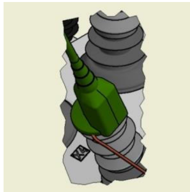
Рис. 4.33. Место подключения провода к коммутационному модулю в сборе
