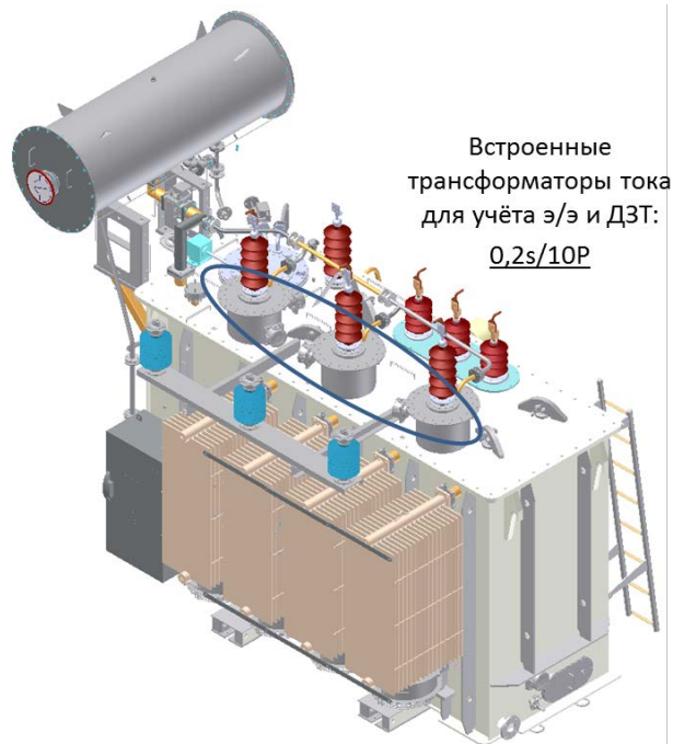
Рис. 3.10. Внешний вид силового трансформатора со встроенными трансформаторами тока
