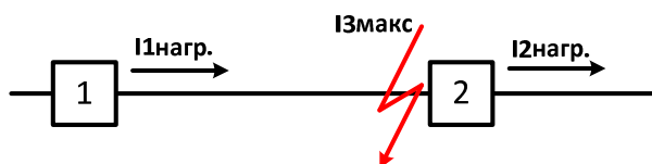
Рис.6.1. Отстройки от мест установки нижестоящих защит
