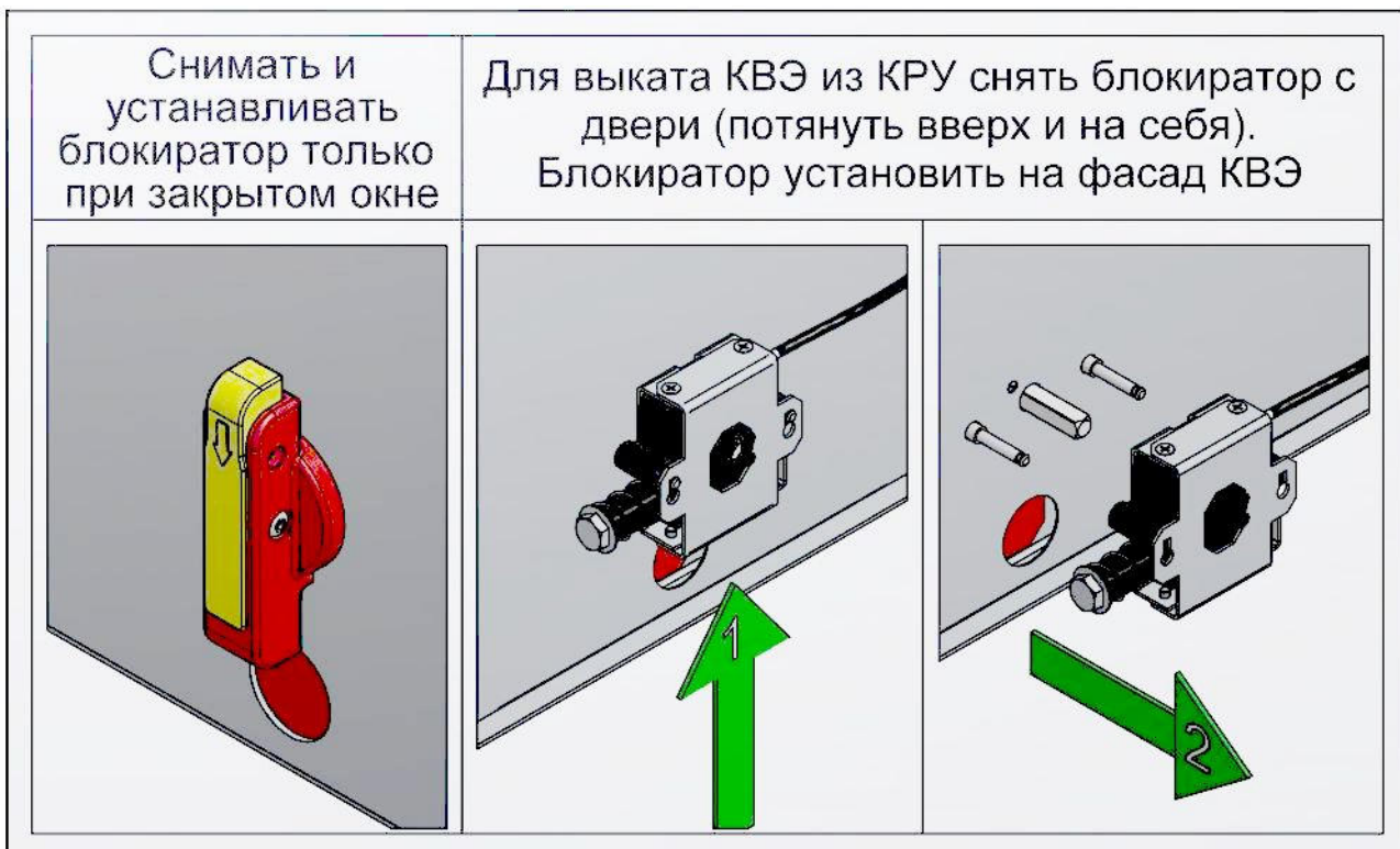
Рис.4.6. Информационная наклейка на внутреннюю часть двери
