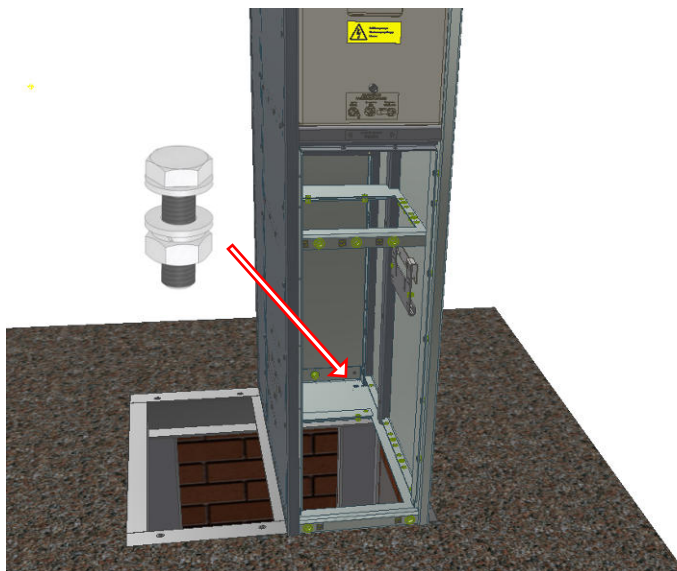
Рис.4.8. Установка первого шкафа ШС на верхнюю поверхность монтажной рамы
