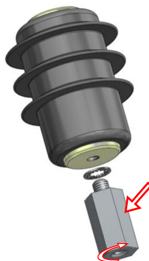
Рис.6.39. Установка переходной гайки в ОПН
