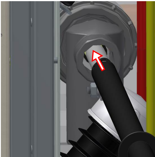
Заведение зажима в проём изолятор
