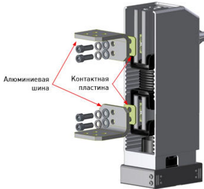
Рис.6.2. Монтаж контактных пластин
