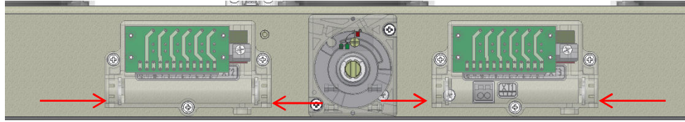
Рис.6.54. Подвод жгута к коммутационному модулю ISM15_LD_8, ISM15_HD_1, ISM15_HD_FT1, ISM15_HD_1S
