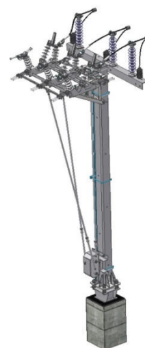
Узел вводного разъединителя с защитой трансформатора
