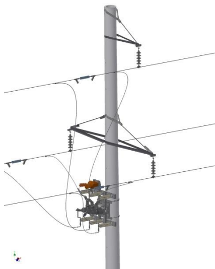
Рис.7.10. Установка реклоузера на стойку СК22
