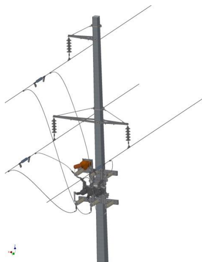
Рис.7.11. Установка реклоузера на стойку СВ164
