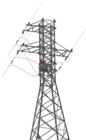
Рис.7.12. Установка реклоузера на опору У35-1
