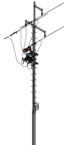
Рис.7.15. Установка реклоузера на опору ППт35-2 (опора из обсадных труб)
