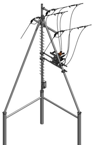
Рис.7.16. Установка реклоузера на опору ПУАт35-1 (опора из обсадных труб)
