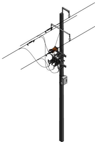
Рис.7.14. Установка реклоузера на стойку СНВ 7-13
