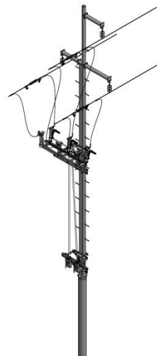
Рис.7.22. Установка разъединителя на опору ППт35-2 (опора из обсадных труб)
