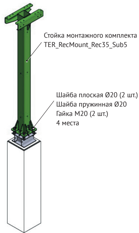
Рис. 5.33. Установка стойки монтажного комплекта на кронштейн регулировочный
