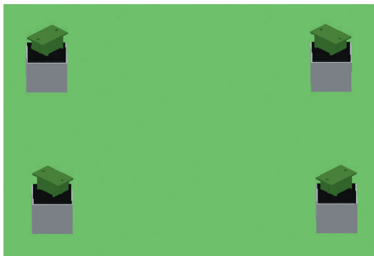
Рис. 5.4. Приваренные к оголовку сваи крепежные элементы (фланцы) антенно-прожекторной мачты ПМС-24.0
