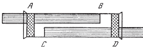
Рис. 9-4 Когерер А.С. Попова (электроды АВ и CD из тонкой листовой платины).
